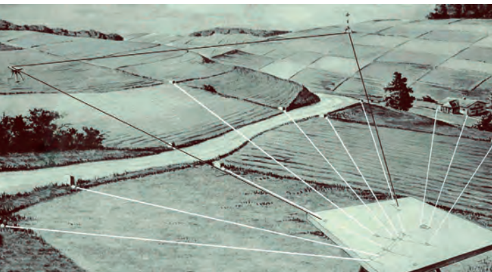
Abb. 95: Schematische Darstellung des Messtischverfahrens
