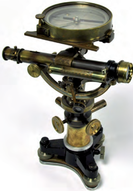
Abb. 059: Bussolentachymeter (Topometer) der Münchner Firma Ertel & Sohn, 1920
