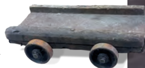
Abb. 115: Historischer Transport-Roller für einzelne Lithographiesteine
